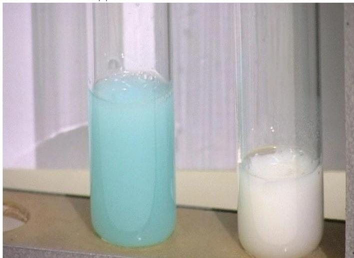
В две пробирки налейте по 1 – 2 мл. раствора белка и медленно, при встряхивании, по каплям добавьте в одну пробирку насыщенный раствор медного купороса, в другую – раствор ацетата свинца. Отметьте образование трудно растворимых солеобразных соединений белка. Данный опыт иллюстрирует применение белка как противоядия при отравлении солями тяжелых металлов.
